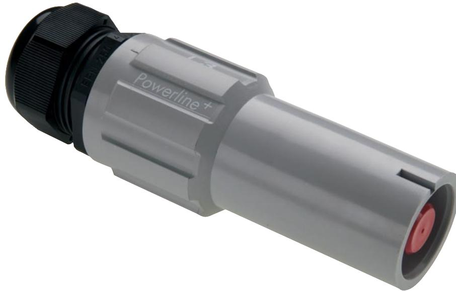
I connettori femmina da cavo sono usualmente utilizzati dalla parte sotto tensione o di alimentazione del circuito. Anche quando non sono accoppiati sono protetti contro il contatto accidentale secondo la normativa IP2X. L'operatore non è quindi in grado di poter toccare parti sotto tensione.
